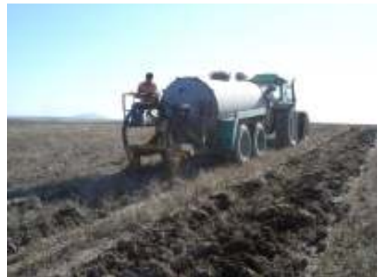
4. Injetor de Lamas em profundidade no solo
